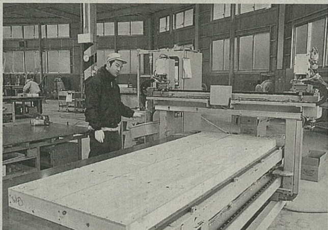
独自開発した自動くぎ打ち機。安定した品質を保つ ＝浜松市天竜区春野町のコーチ
